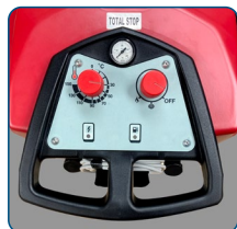
Sencillo cuadro de control de temperatura y on/off
